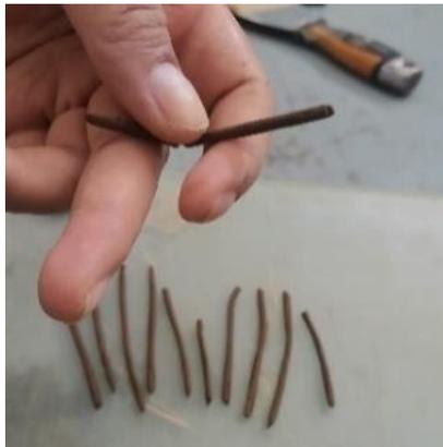
Ilustración 53. Colocación de cilindros sobre 2 dedos y presionando ligeramente para comprobar si se rompe. Fuente: M. Ruiz-Mendoza.
