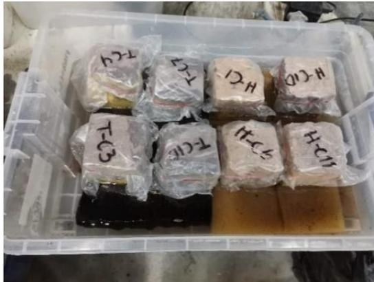
Ilustración 64. Especímenes dentro del contenedor previamente preparado. Fuente: M. Ruiz-Mendoza.
