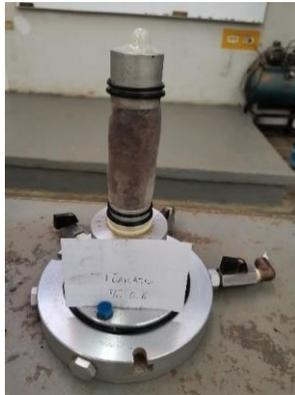
Ilustración 60. Espécimen colocado sobre la base inferior de la cámara triaxial con la membrana y bandas de hule. Fuente: M. Ruiz-Mendoza.
