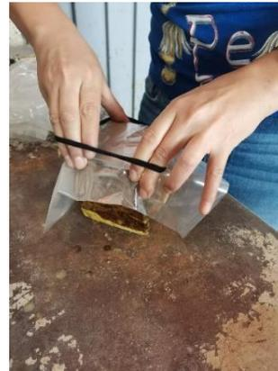
Ilustración 63. Cubriendo la cara superior del espécimen con una bolsa de hule y una banda elástica. Fuente: M. Ruiz-Mendoza.
