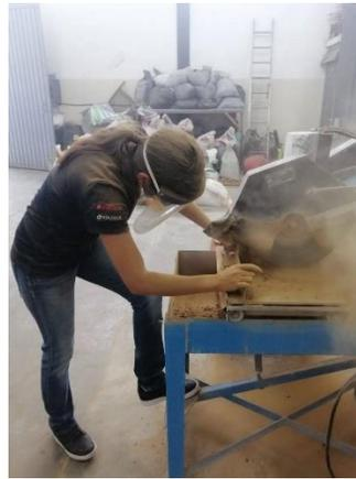
Ilustración 25. Labrado de las muestras en la cortadora. Fuente: M. Ruiz-Mendoza.
