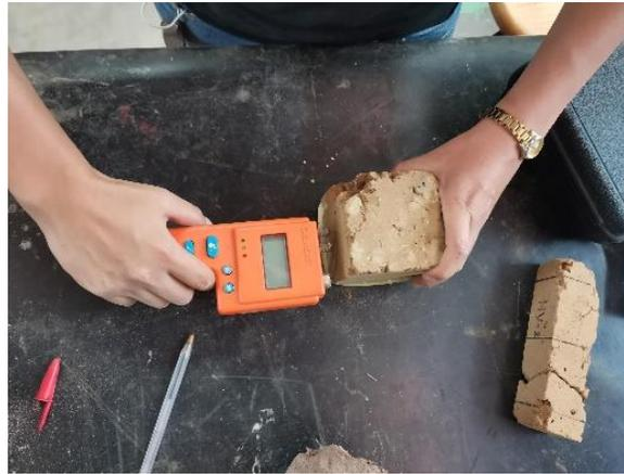
Ilustración 32. Determinación de la humedad relativa con el equipo Contractor's Moisture Meter, BD-2100, Delmhorst. Fuente: M. Ruiz-Mendoza.
