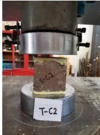
Ilustración 43. Espécimen cubico (T-C2) siendo ensayado a compresión simple. El espécimen se encontraba en muy buen estado, no se observó ninguna falla previa al ensayo y su ausencia de material es básicamente nula. Fuente: M. Ruiz-Mendoza.
