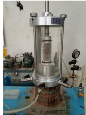
Ilustración 61. Cámara triaxial colocada en la prensa, llena de agua y conectada al tanque regulador. Fuente: M. Ruiz-Mendoza.
