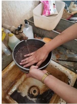
Ilustración 46. Lavado de la muestra para eliminar los finos y dejar únicamente las arenas. Fuente: M. Ruiz-Mendoza.
