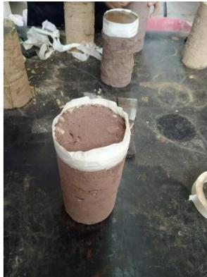
Ilustración 37. Colocación de cinta masking alrededor de la cara que se va a cabecear.
