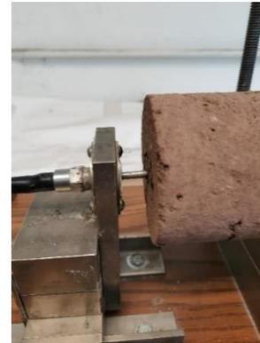
Ilustración 35. Ajuste del equipo en el centro de la cara del espécimen. Fuente: M. Ruiz-Mendoza.
