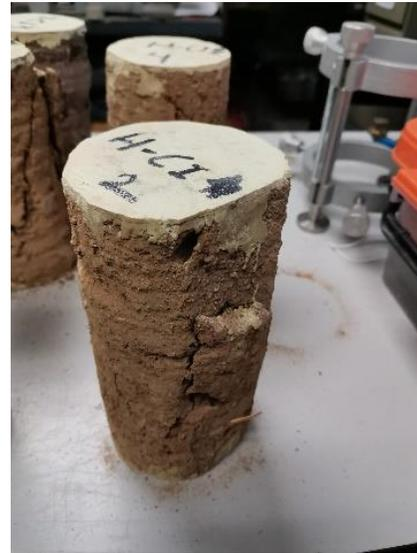
Ilustración 69. Espécimen H-CI2 posterior al ensaye de módulo de elasticidad. Fuente: M. Ruiz-Mendoza.
