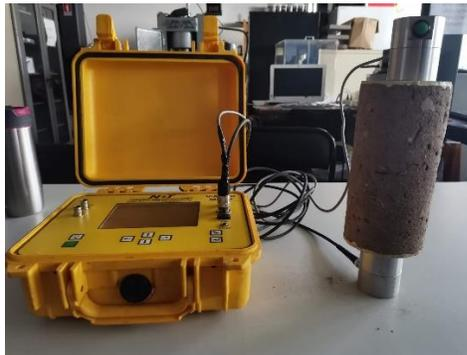
Ilustración 36. VPU (medición directa) con el equipo V METER MK IV.
