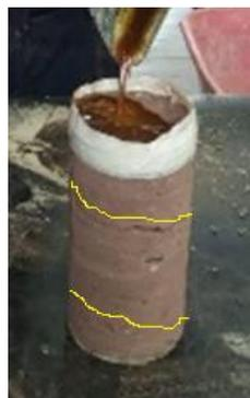
Ilustración 73. Especimen T-CI1 antes de ser ensayado. Presentaba 2 fracturas horizontales, las cuales no atravesaban en su totalidad la sección transversal del espécimen. Fuente: M. Ruiz-Mendoza.
