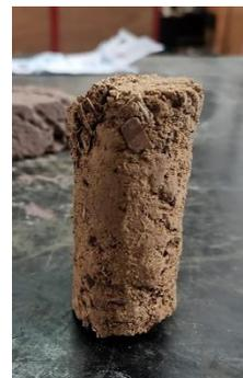
Ilustración 31. Cilindro de 3.5cm de diámetro.
