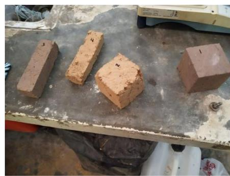
Ilustración 27. Cubos y vigas labrados en cortadora. Fuente: M. Ruiz-Mendoza.
