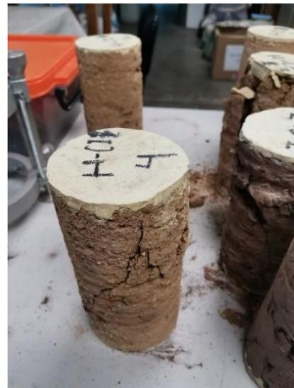
Ilustración 71. Espécimen H-CI4 posterior al ensaye de módulo de elasticidad. Fuente: M. Ruiz-Mendoza.
