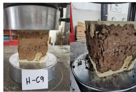
Ilustración 75. Especimen H-C9 antes y después del ensayo de compresión simple.
