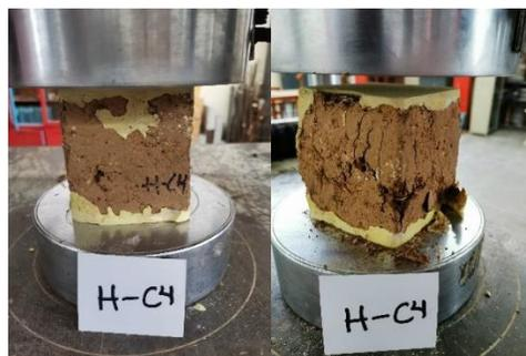
Ilustración 74. Especimen H-C4 antes y después del ensayo de compresión simple.
