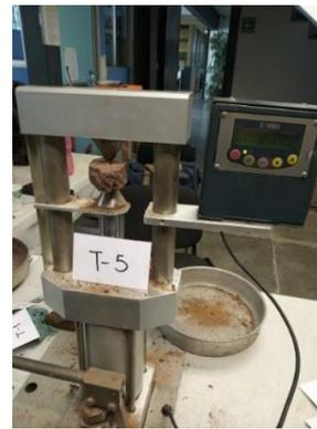
Ilustración 57. Colocación del espécimen en la prensa de carga puntual. Fuente: M. Ruiz-Mendoza.
