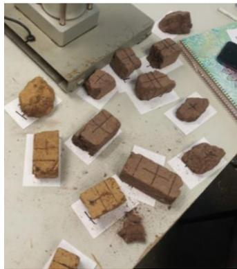
Ilustración 56. Se marco el centro de la muestra sobre el cual aplicara la carga.
