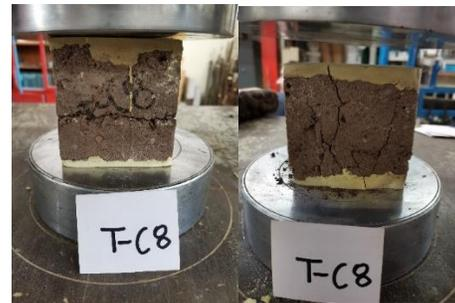
Ilustración 77. Espécimen T-C8 antes y después del ensayo de compresión simple.
