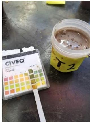
Ilustración 59. Comparación de la tira reactiva con la tabla colorimétrica de la caja. Fuente: M. Ruiz-Mendoza.
