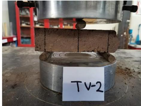
Ilustración 44. Viga marcada y colocada en la prensa para el ensaye de flexión. Fuente: M. Ruiz-Mendoza.
