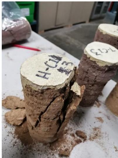
Ilustración 70. Espécimen H-CI3 posterior al ensaye de módulo de elasticidad. Fuente: M. Ruiz-Mendoza.
