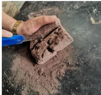
Ilustración 28. Labrado del cilindro (paso No.2).
