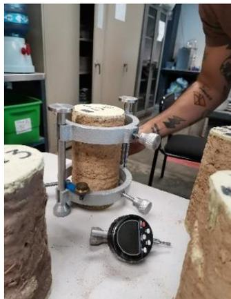
Ilustración 41. Instalación del deformímetro con el espécimen al centro.
