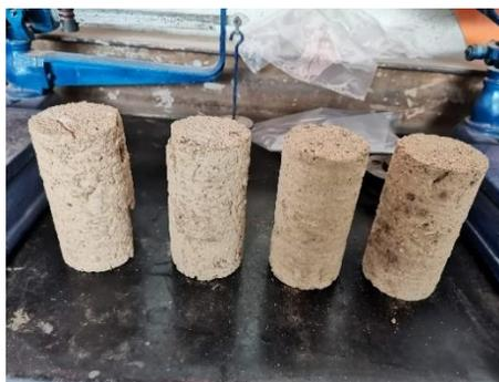
Ilustración 26. Cilindros de 10cm de diámetro labrados en cortadora. Fuente: M. Ruiz-Mendoza.
