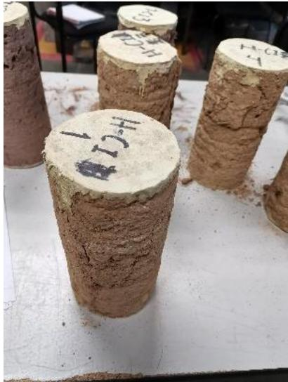
Ilustración 68. Espécimen H-CI1 posterior al ensaye de módulo de elasticidad. Fuente: M. Ruiz-Mendoza.
