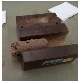
Ilustración 30. Labrado de cilindro (paso No. 4).
