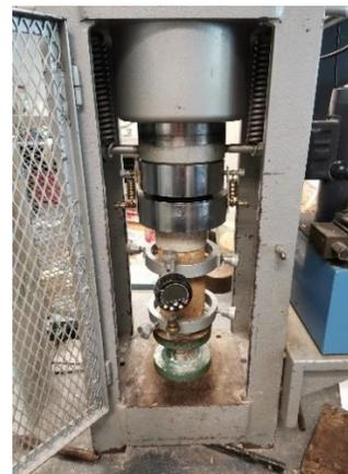
Ilustración 42. Ensayo del módulo de elasticidad. Fuente: M. Ruiz-Mendoza.
