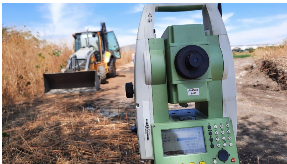
Figura 17. Trabajo de campo: Estación total utilizada Leica TS06, Elaboración propia , 2021.
