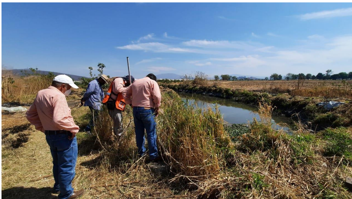
Figura 15. Trabajo de campo: Medición de la sección transversal de la entrada al sifón, Elaboración propia , 2021.
