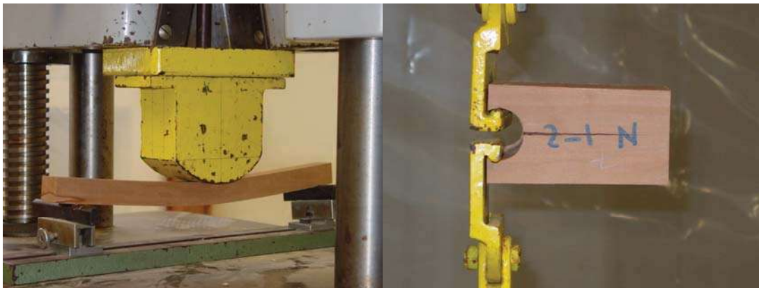
Figura 16.- Pruebas de flexión y resistencia a rajaduras.
