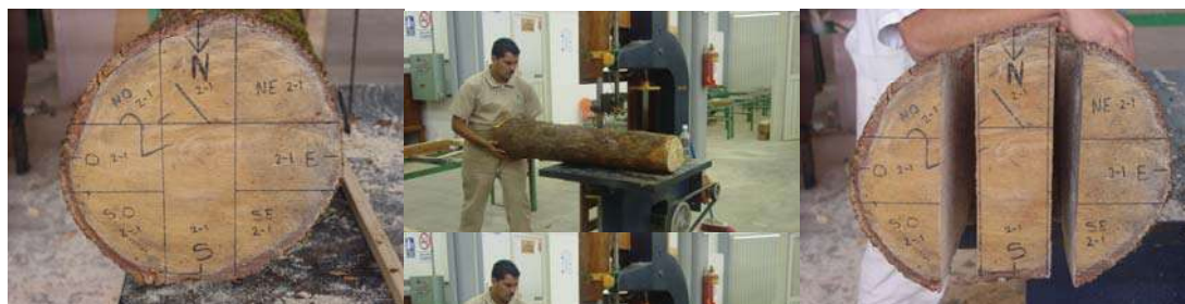
Figura 11.- Obtención de listones con caras radiales y tangenciales paralelas entre si.
