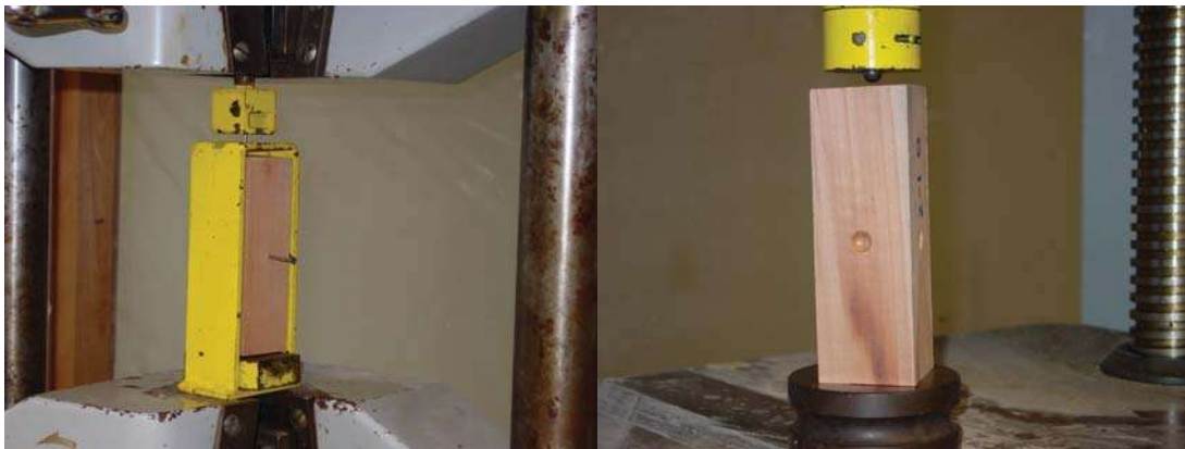
Figura 19.- Pruebas de extracción de clavos y dureza janka.
