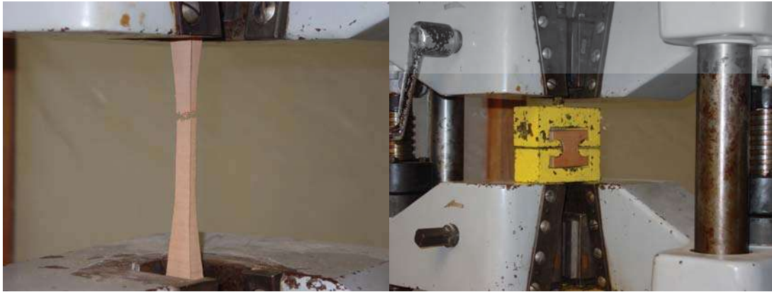
Figura 18.- Pruebas de tensión paralela y perpendicular a la fibra.
