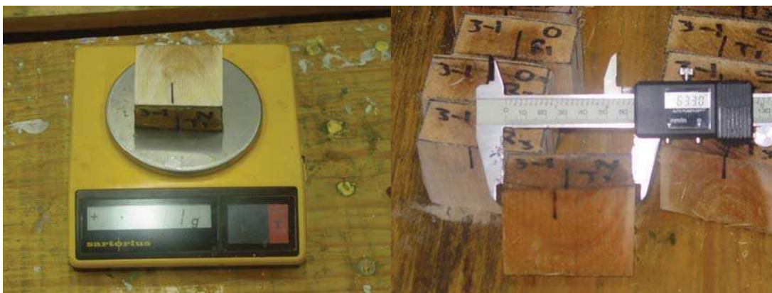
Figura 10.- Balanza y vernier digitales utilizados en las determinaciones de las mediciones y pesos.
