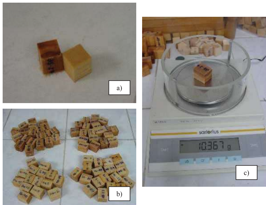
Figura 11. Equipo y material utilizado para la realización de las pruebas físicas; a) Probeta de albura y de duramen; b) Conjuntos de probetas para pruebas físicas (albura y duramen); c) Balanza de digital de 0.001gr de precisión
