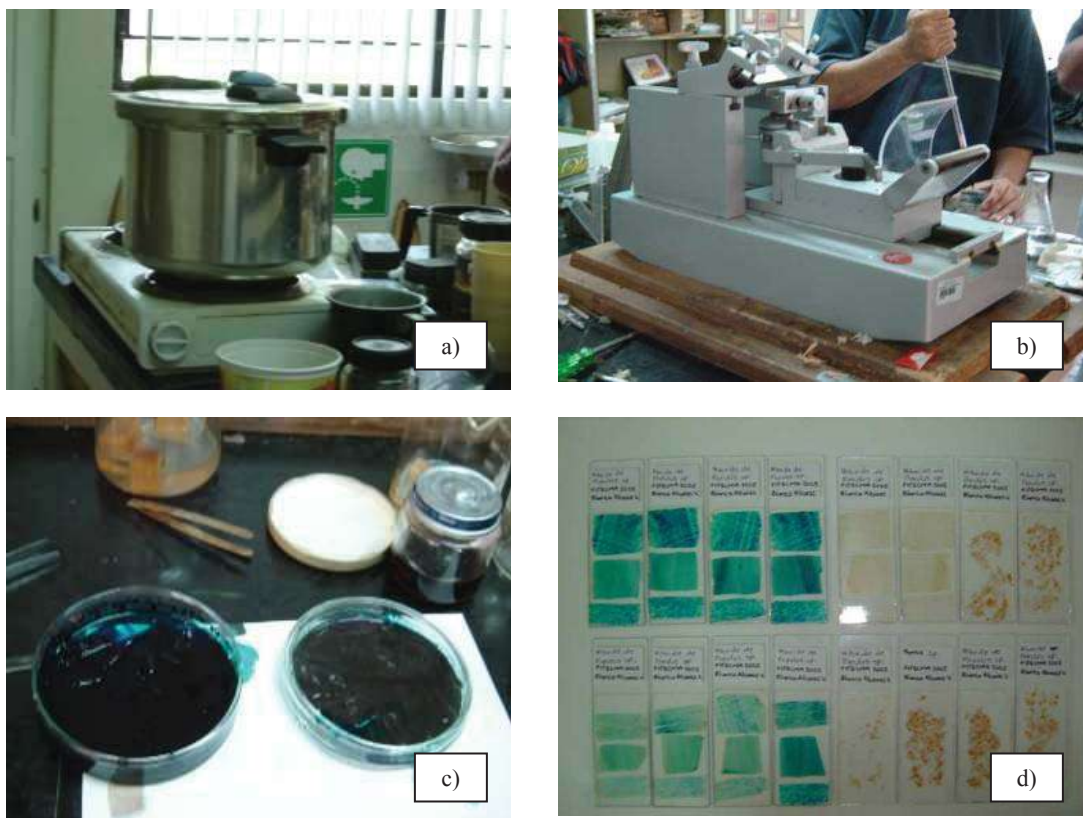
Figura 8. Equipo utilizado para la elaboración del material disociado y preparaciones fijas; a) Olla de presión; b) Microtomo de deslizamiento; c) Entintado de los cortes típicos en cajas de petri; d) Material montado y etiquetado
