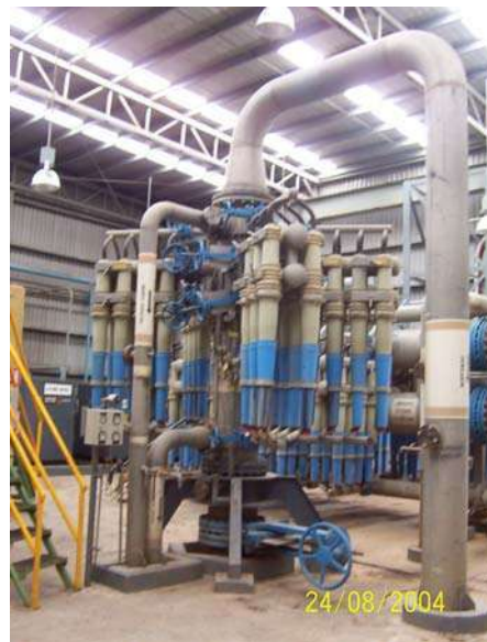
Figuras 47.- Limpiador o depurador ciclónico satélite
