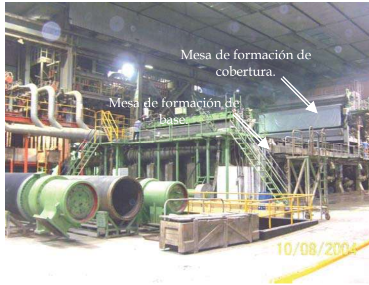
Figura 57.- Mesa de formación de base y cobertura.
