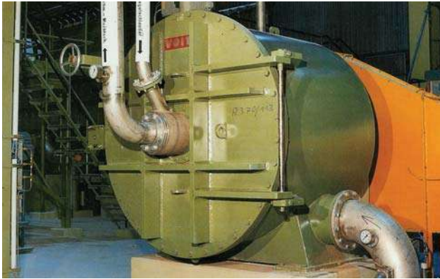
Figuras 33.- Turbo separador utilizado en la industria CENTAURO.
