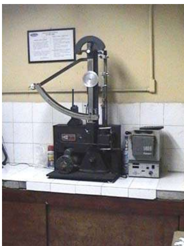
Figura 14.- Equipo para realizar las pruebas de fuerza de tensión, Absorción de la energía de tensión, resistencia al rasgado y rigidez.
