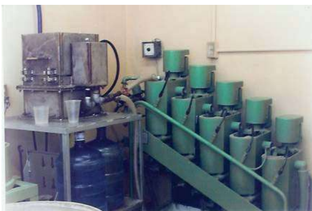
Figura 15.- Recuperador de fibras ó finos.
