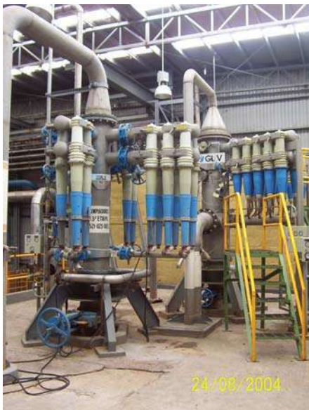
Figuras 47.- Limpiador o depurador ciclónico satélite
