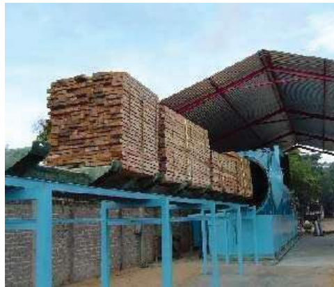
Figura 5. Madera preservada en la autoclave de la empresa Maderería Río Dorado S.A. de C.V.
