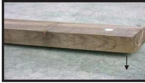
Figura 4. Determinación de la torcedura.
