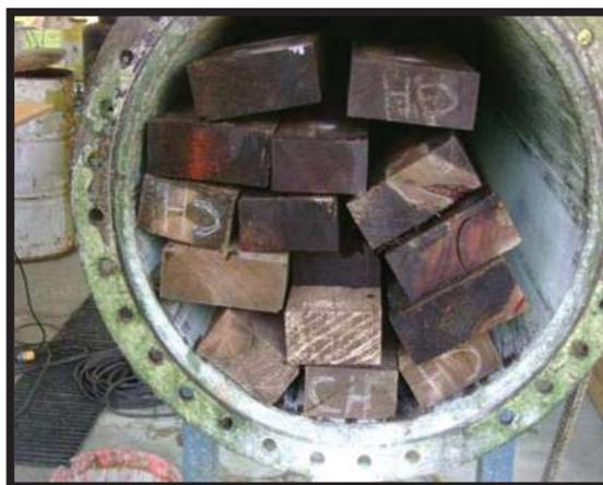
Figura. 6. Madera en el autoclave.
