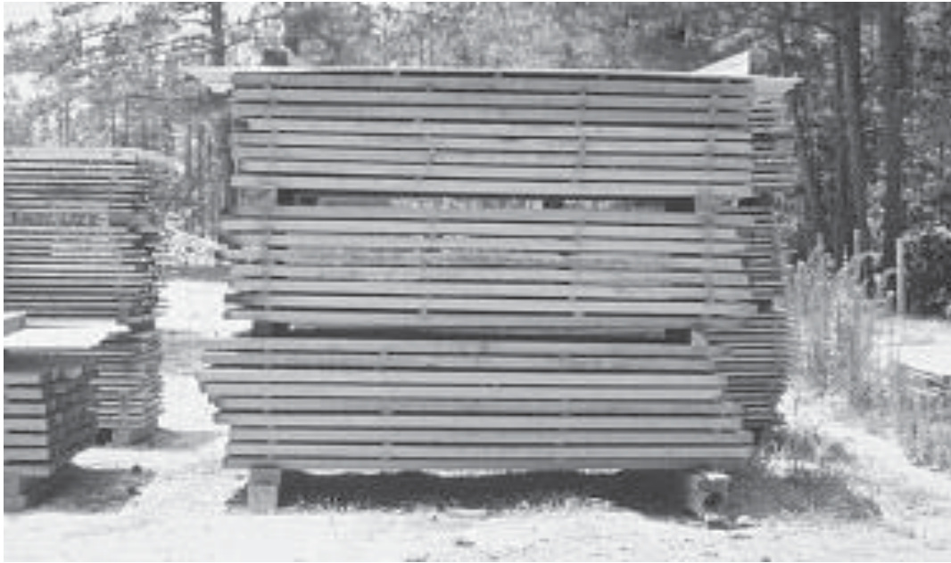
Figura 1. Pila de madera en forma rectangular con techos de lámina.
