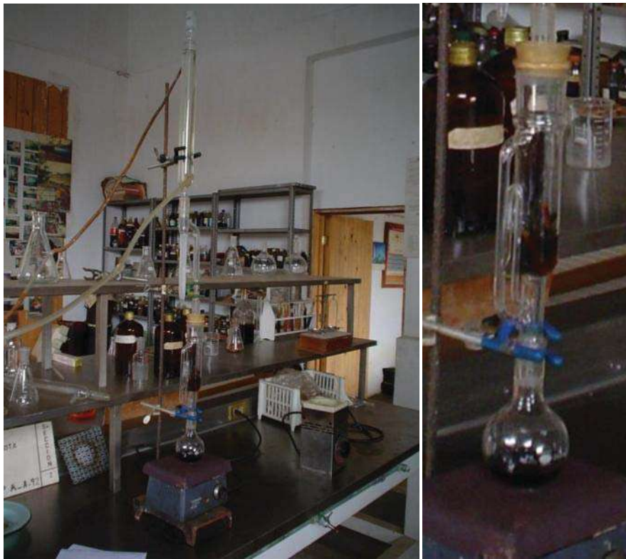
FIGURA No. 12 Prueba para determinar la retención del preservante. Planta de impregnación de las Vigas de Rafael Ramírez, Ver.
