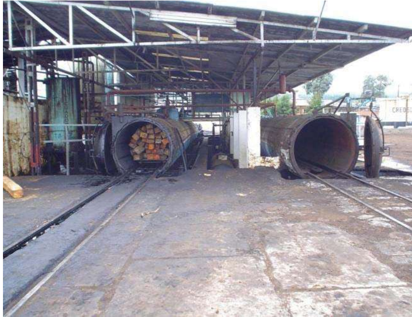
FIGURANo. 2 Vista parcial de los cilindros de tratamiento en Impregnadora Las Vigas de Rafael Ramírez, Ver.
