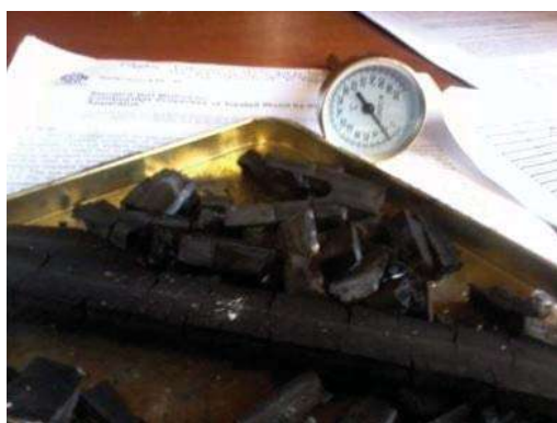
Figura 6. Cenizas de probeta impregnada con pentaclorofenol.
