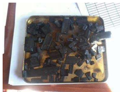
Figura 7. Cenizas de probeta impregnada con sales de boro.
