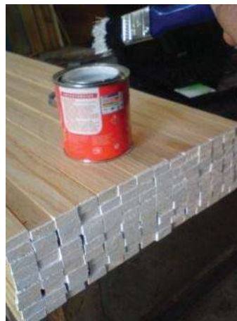
Figura 2. Sellado de las cabezas con pintura de aceite.
