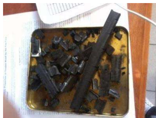
Figura 9. Cenizas de probeta utilizada como testigo.
