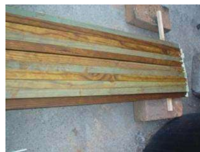
Figura 3. Probetas impregnadas con sales CCA-C.
