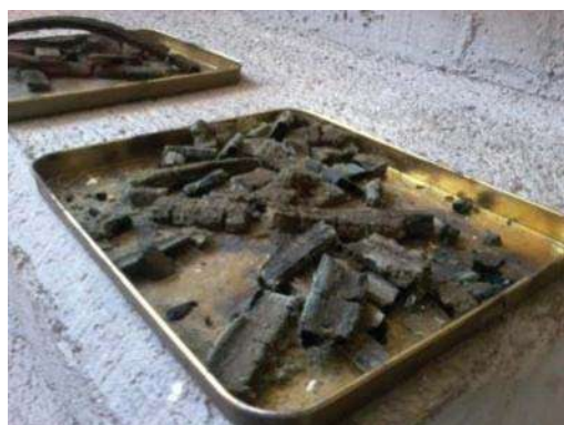
Figura 8. Cenizas de probeta impregnada con sales CCA-C.
