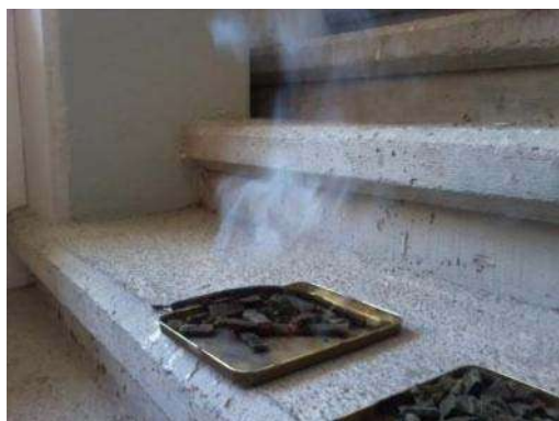
Figura 4. Desprendimiento de humo en probeta impregnada con CCA-C.
