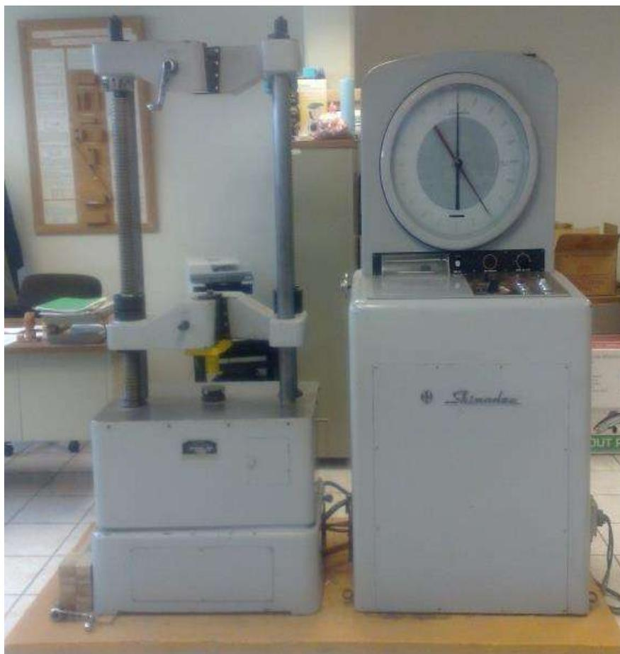
**Figura 24.** Máquina Universal con capacidad de 10 000 kg.
