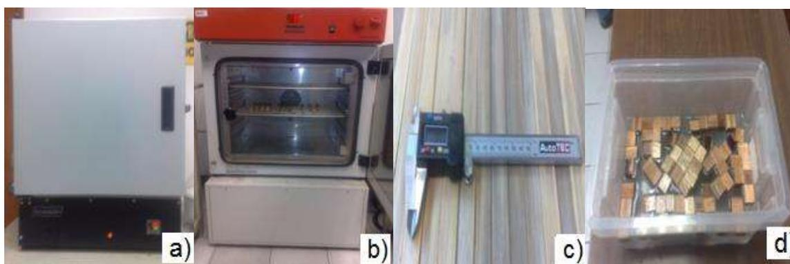
**Figura 23.** Equipo utilizado para determinación de Hinchamiento: **a**) Estufa de desecación; **b**) Cámara de acondicionamiento; **c**) Vernier digital **d**) Recipiente con agua destilada.
