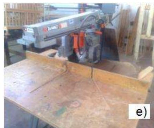
**Figura 19.** Equipo utilizado para la elaboración de probetas requeridas en los ensayos físicos y mecánicos; **a)** Aserradero; **b)** Cepillo; **c)** Canteador; **d)** Sierra circular; **e)** Sierra radial.
