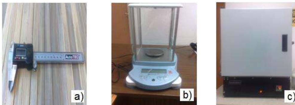
**Figura 21.** Equipo utilizado para la determinación de la densidad; **a)** Vernier digital; **b)** Balanza; **c)** Estufa de desecación.
