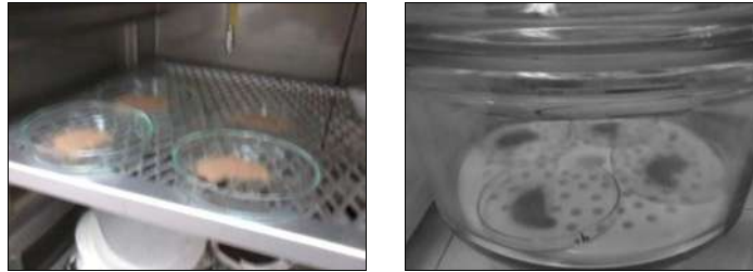
Figura 6. Determinación de porcentaje de humedad.
