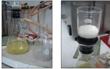
Figura 13. Determinación de \alpha - celulosa.
