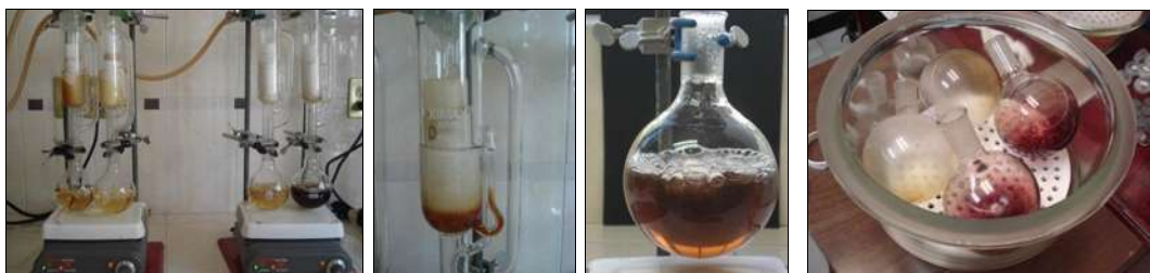
Figura 9. Obtención de extraíbles en equipo Soxhlet.
