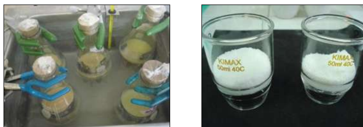
Figura 12. Determinación del porcentaje de holocelulosa.
