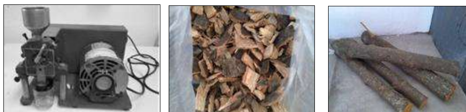
Figura 4. Astillado y molido de las ramas.
