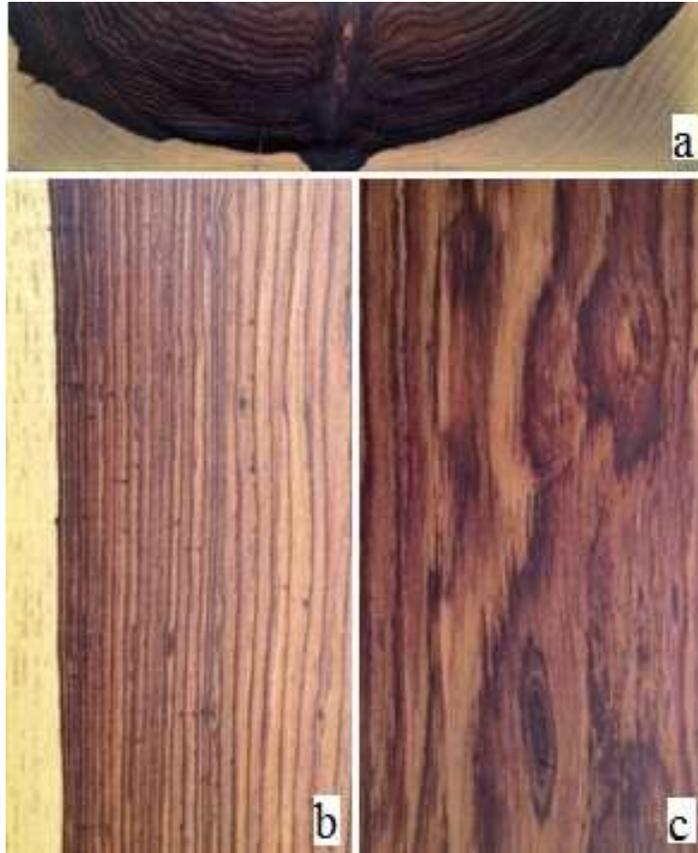
Figura 15: Tablillas de *Dalbergia congestiflora* con cortes típicos. a) transversal, b) radial y c) tangencial
