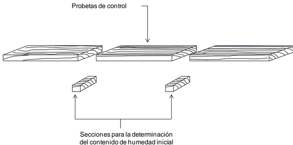
Figura 3.2. Obtención de las probetas de control
