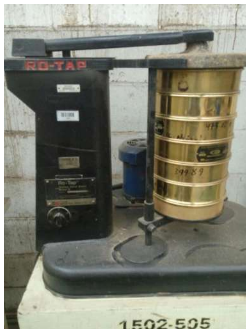
Figura 32. Equipo agitador de cribas Marca RO-TAP
