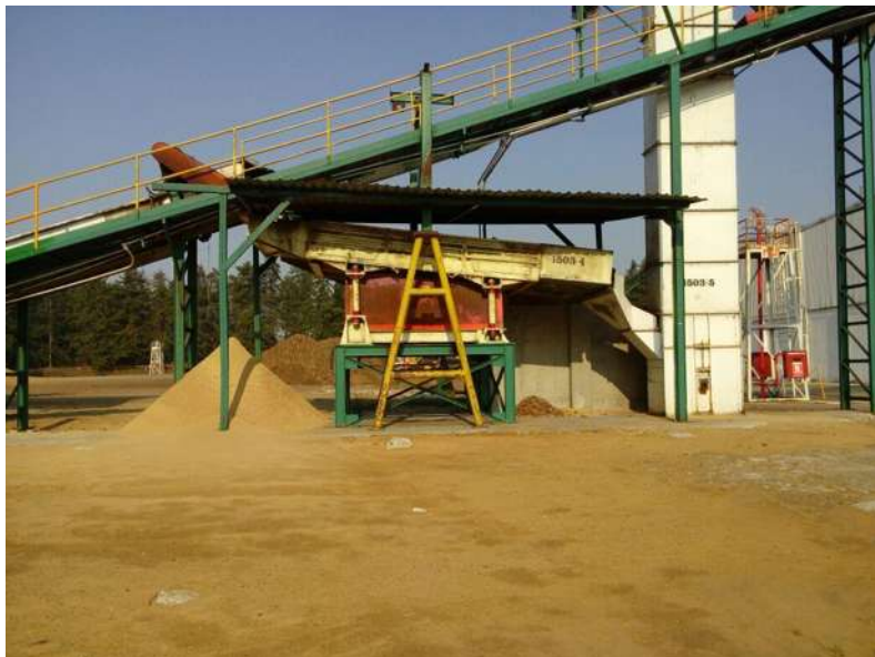
Figura 7. Proceso de cribado con malla de 3/8" de abertura.
