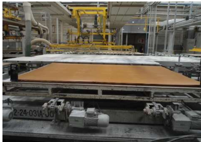
Figura 25. Línea de laminación de una planta de aglomerado.
