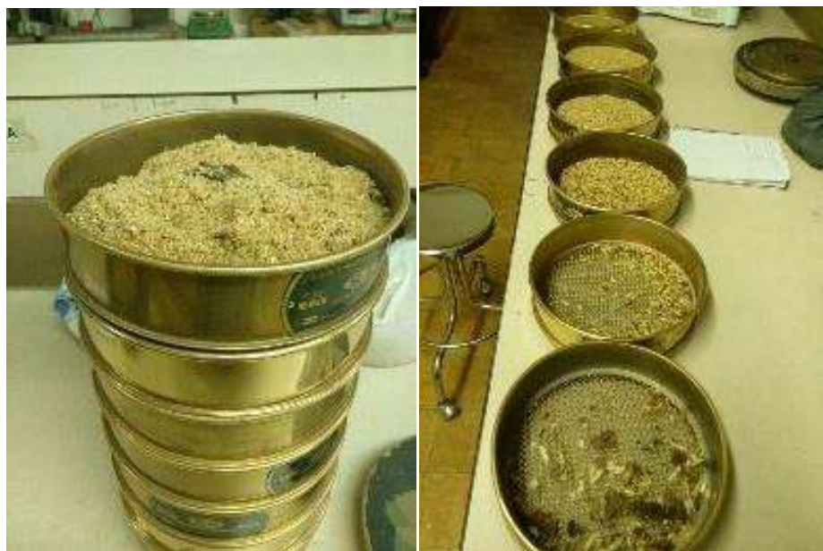
Figura 33. Material antes y después de ser cribado a nivel laboratorio.
