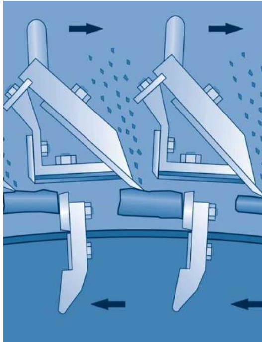
Figura 51. Detalle en el principio de corte de los hojeladores.
