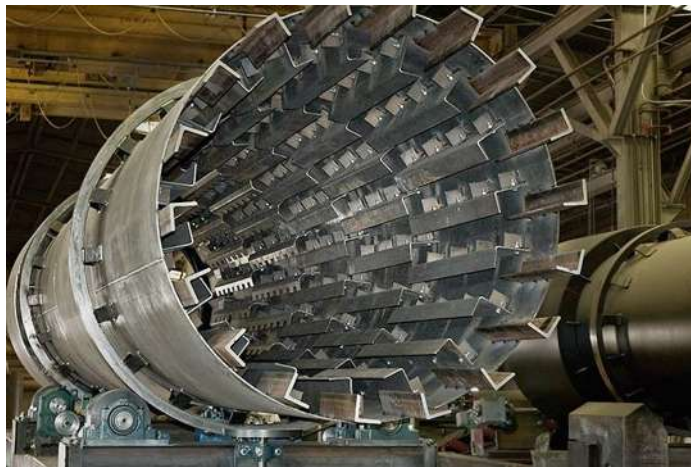
Figura 18. Detalle de las placas metálicas del interior de un tambor rotativo.
