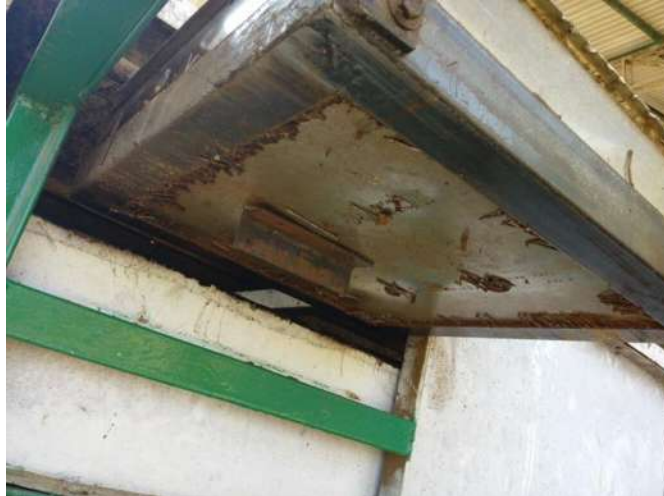
Figura 4. Detalle del sistema magnético en la banda.
