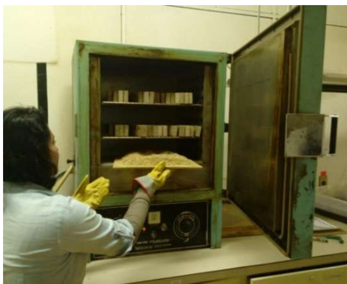
Figura 30. Colocación de la muestra húmeda a la estufa del laboratorio.
