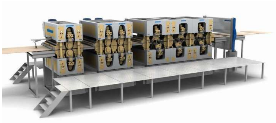
Figura 23. Secuencia de lijado del tablero.
