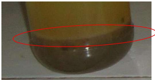
**Figura A 1.** Separación oleorresina-tierra de la fracción de lodos o colas
