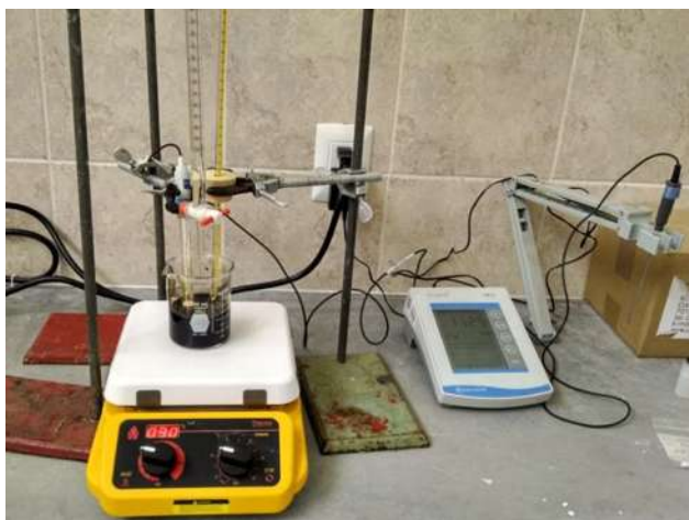
Figura 14. Montaje del equipo para la acidificación del licor negro (Fuente: propia).
