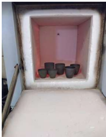
Figura 24. Crisoles dentro de la mufla.
