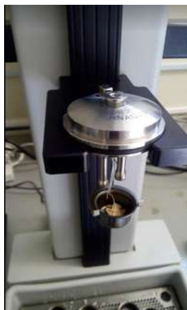
Figura 20. Colocación del hilo de celulosa.
