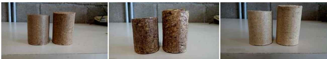
Figura 12. Diferencia de la misma muestra de briquetas antes y después del acondicionamiento.
