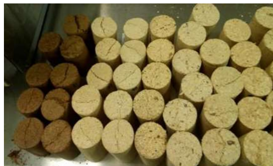
Figura 16 Briquetas después del ensayo.
