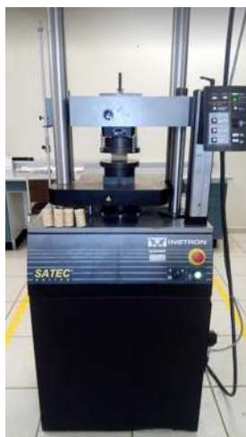
Figura 13 Máquina universal Instron.
