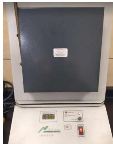
Figura 25. Material volátil a 900 °C.
