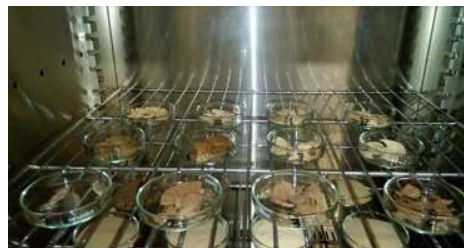
Figura 18. Muestras en el horno a 105° C.
