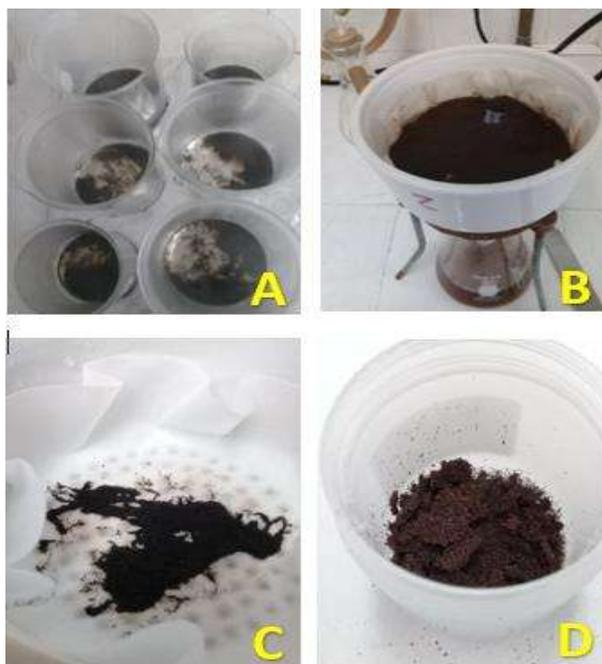
**Figura 6.** Obtención de lignina Runkel. Hidrólisis ácida de la holocelulosa usando ácido sulfúrico al 72% y ácido bromhídrico al 40% (A), filtrado y lavado de lignina (B), lignina deshidratada (C), lignina almacenada (D).
