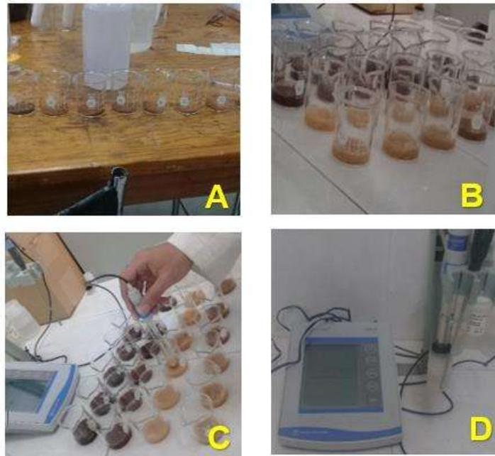
**Figura 2.** Determinación de pH. (A, B) Se observa la preparación de las muestras (A, B), la determinación del pH (C), así como también el equipo con el que se realizó el análisis (D).
