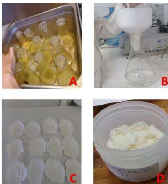
**Figura 5.** Obtención de holocelulosa. Se muestra el proceso de deslignificación de la muestra (A), filtrado y lavado de holocelulosa (B), holocelulosa (C), holocelulosa almacenada (D).
