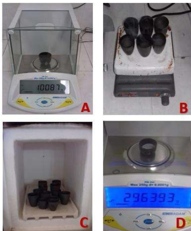
**Figura 3.** Determinación de cenizas. Se muestra en el orden siguiente: peso conocido de la muestra (A), muestra sometida a calor en placa de calentamiento para eliminar material volátil (B), muestra sometida a calor vía mufla a 550 °C (C) y finalmente, peso final de la muestra (D).
