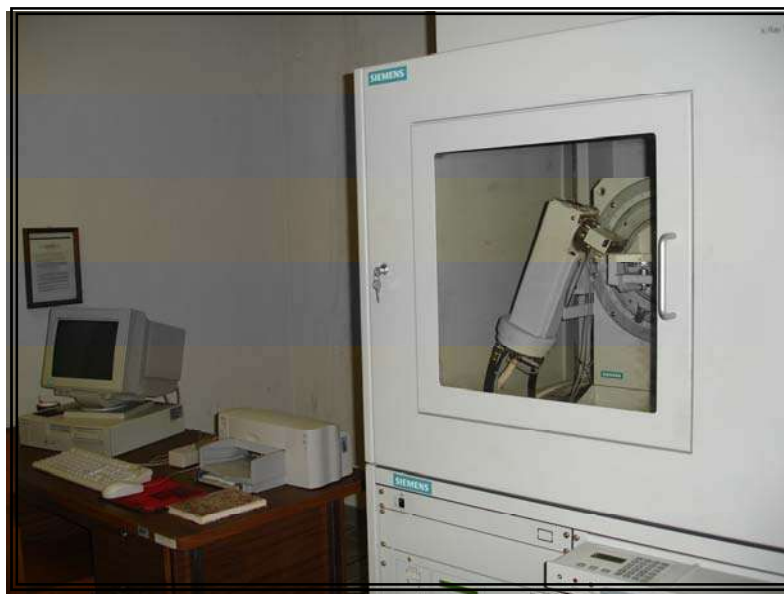
Imagen 4.3.- Equipo de difracción de rayos X SIEMENS modelo D5000 utilizado en la caracterización de catalizadores de ZrO_2-Al_2O_3 , en el Instituto de Investigaciones Metalúrgicas de la UMSNH.
