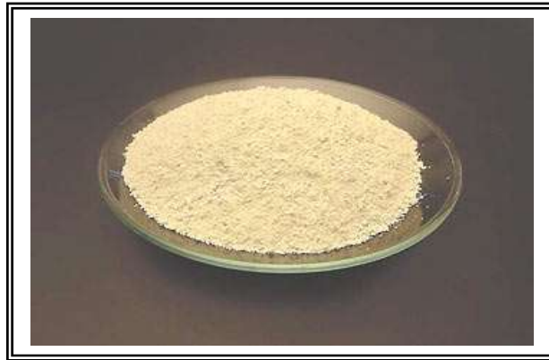
Imagen 5.3.- Polvos obtenidos después del proceso de calcinación del Sistema ZrO_2-Al_2O_3 , de composición 60:40 % respectivamente.
