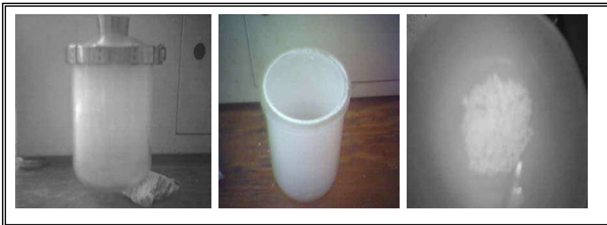
Imagen 4.2.- Polvo obtenido por medio del secado por pulverización en el Mini Spray-Dryer del sistema mixto \text{ZrO}_2\text{-Al}_2\text{O}_3 con composición 20\text{-}80\% .
