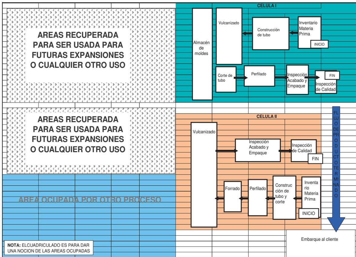
FIGURA 15. Disposición del Equipo de Proceso convertido a Manufactura Celular
