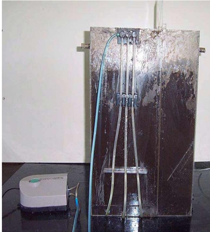
**Figura 2.6. Reactor biológico por medio de lodos activados o biorreactor.**
