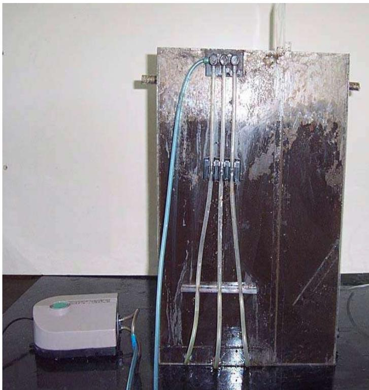
**Figura 3.6. Biorreactor tomado por la parte delantera trabajando con la mezcla lodos activados – agua residual.**
