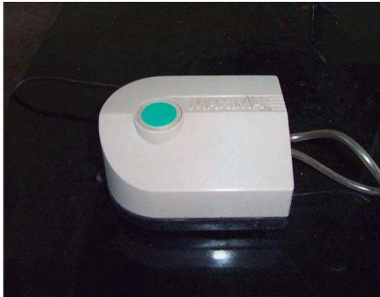
**Figura 4.1. Bomba de diafragma marca *Maxima*.**
