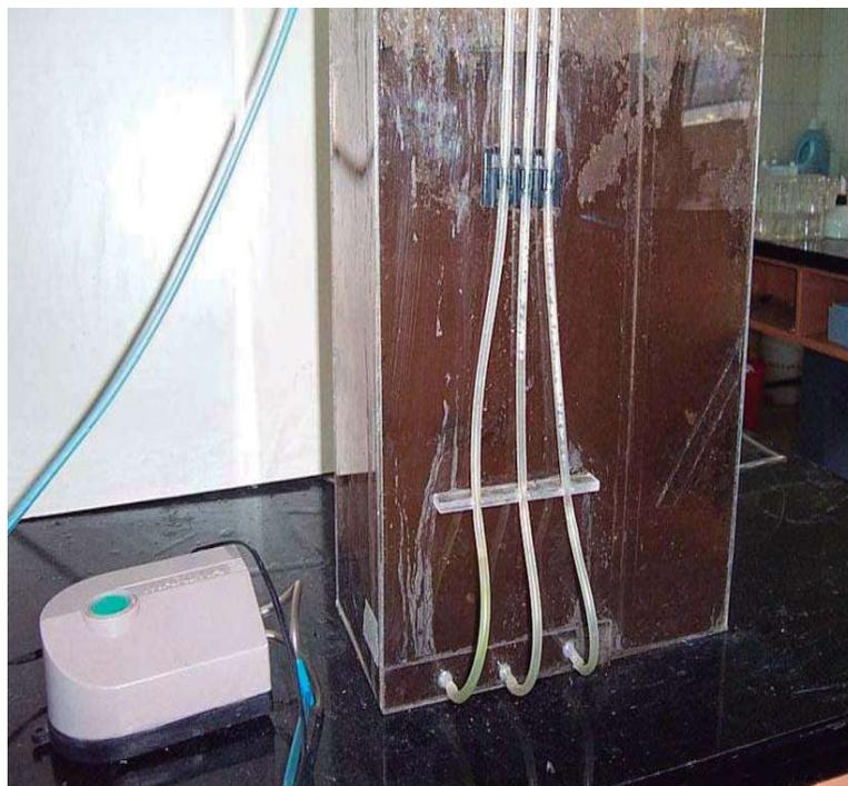
**Figura 3.7. Biorreactor tomado por la parte delantera mostrando el clarificado en la parte superior y en la parte inferior los lodos activados sedimentados.**
