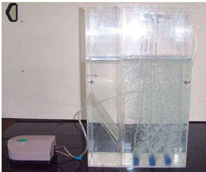
**Figura 3.4. Biorreactor tomado por la parte trasera, funcionando con agua clara para observar el funcionamiento del mismo así como las partes que lo conforman.**
