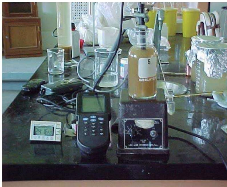
**Figura 2. Prueba para la determinación de Oxígeno disuelto.**
