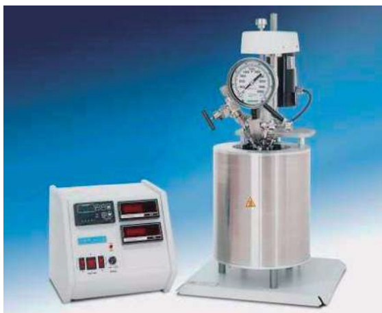
Figura 2.3. Reactor utilizado para la prueba de actividad catalítica
