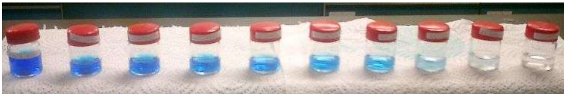
Figura 25. Efecto de la radiación UV en la prueba C.
