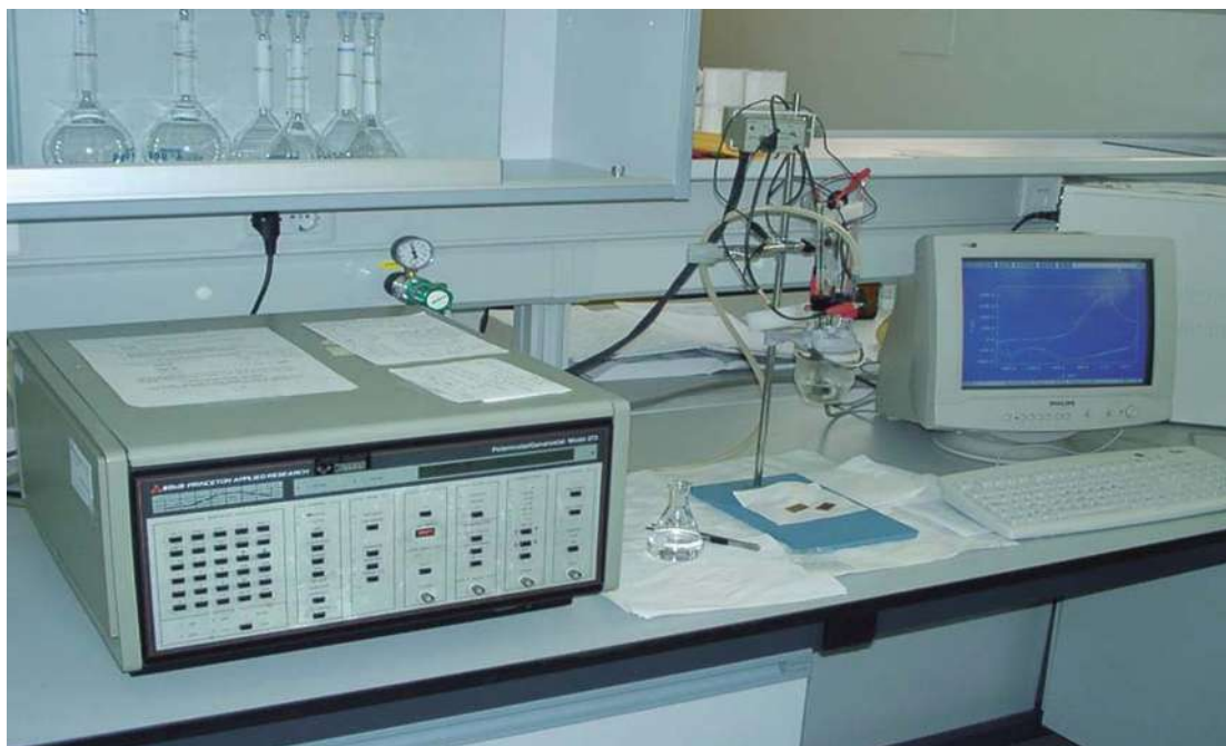
Figura 5.1 Potencióstato / Galvanostato. Marca “Gamry Instruments”.
