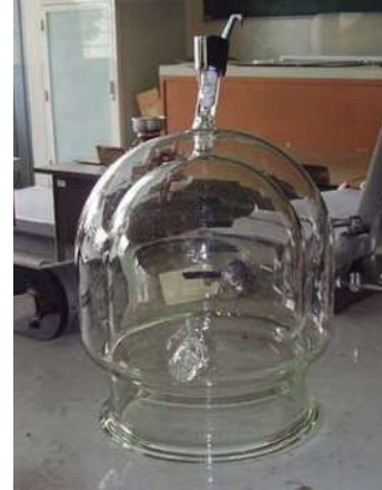
Figura A8. Tanque del reactor.
