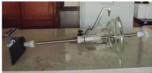
Figura A4. Tapa del reactor unida al motor y la propela
