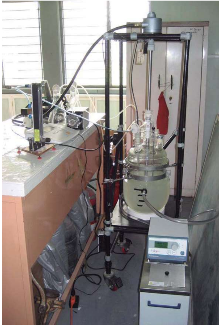
Figura 4.17. Reactor de tanque agitado, acondicionado para fermentaciones aerobias.
