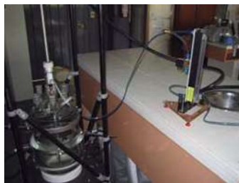
Figura 4.4. Sistema de alimentación de aire al medio.
