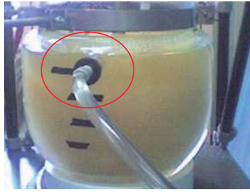
Figura 4.10. Instalación del baño termocirculador a la chaqueta del reactor.
