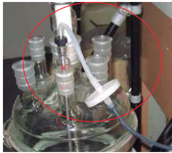
Figura 4.6. Filtro pirinola instalado justo antes de la entrada al difusor.
