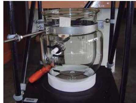
Figura A5. Tanque del reactor.
