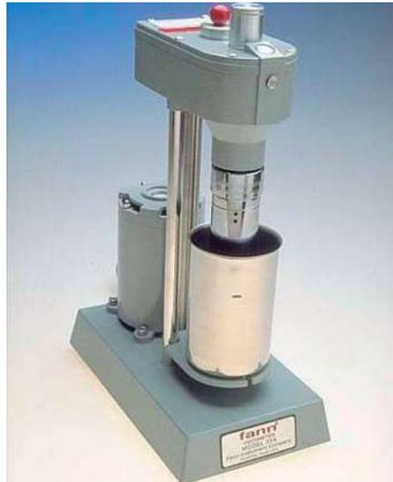
Fig.14.-Viscosímetro de indicación directa típico.
