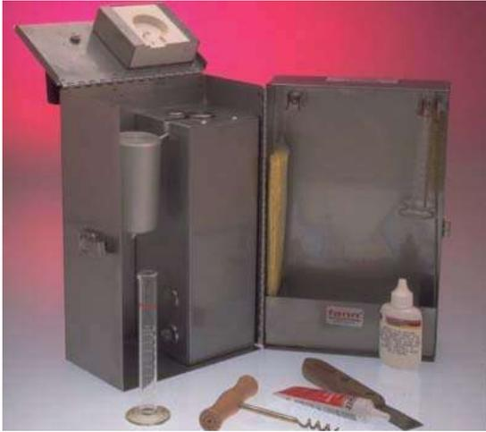
Fig. 17.- Retorta para determinar sólidos, aceites y agua.
