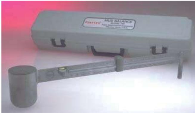
Balanza de lodos (escala vertical).
