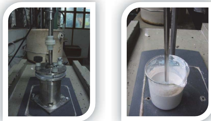
Fig. 10.20 Molienda por atrición y Fig. 10.21 Suspensión en homogenización.
