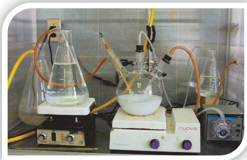
Fig. 10.3 Proceso de obtención de pseudoboehmita
