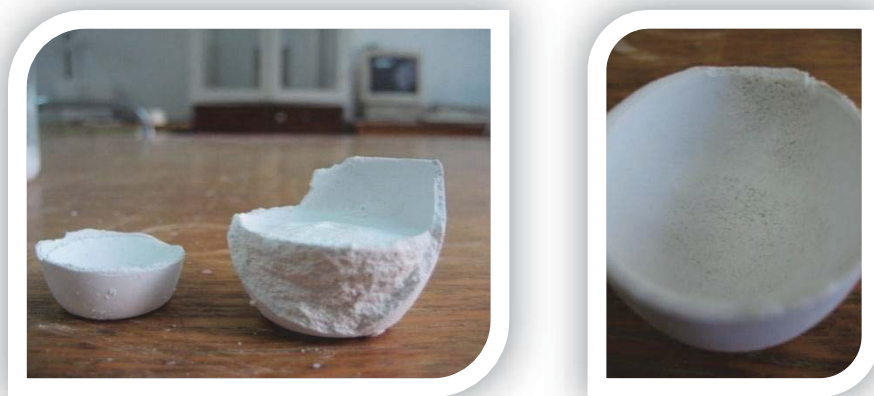
Fig. 11.14 y 11.15 Crisoles mal formados.
