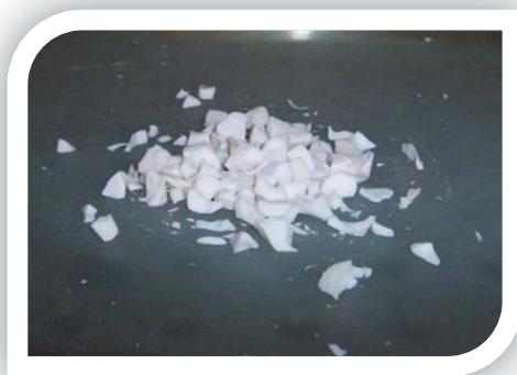
Fig. 10.9 Torta de pseudoboehmita secada a 80°C
