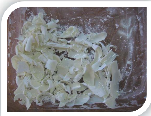
Fig. 10.16 Pseudoboehmita con siembra después de haberse evaporado el agua.
