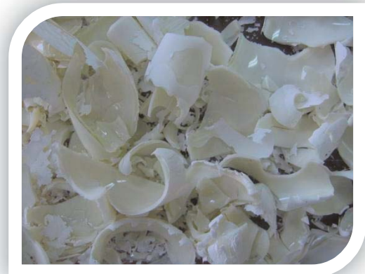
Fig. 10.16 Pseudoboehmita con siembra después de haberse evaporado el agua.
