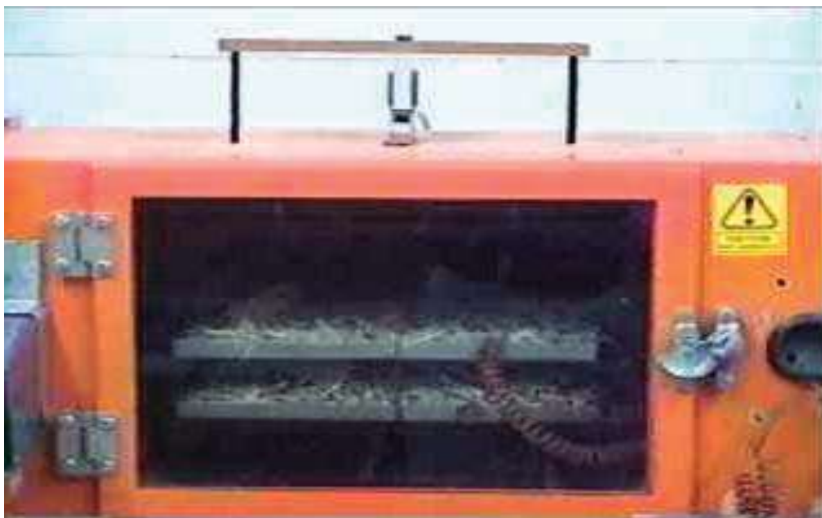
Figura 11. Charolas que contienen el bagazo de caña de azúcar dentro del secador piloto tipo túnel. (Los cables que se pueden observar dentro del secador están en contacto directo con el bagazo, a través de ellos se mide la temperatura del bagazo)
