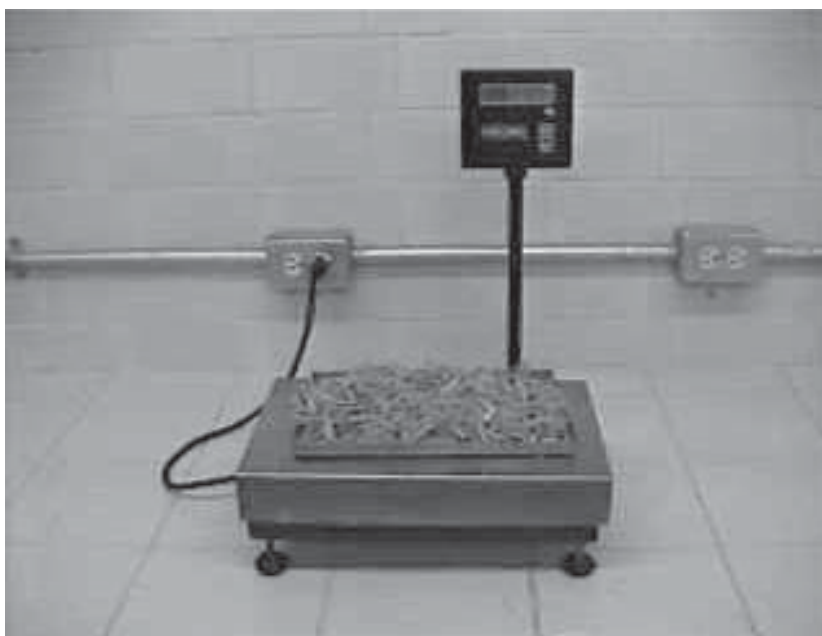
Figura 10. Muestra de bagazo de caña de azúcar libre de humedad colocada en una de las charolas, la cual contiene las siguientes dimensiones: 18.5 cm de ancho, 27.5 cm de largo, 2.5 cm de alto y 430 g de peso.
