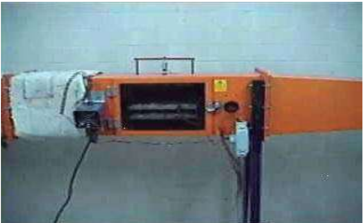
Figura 12. Secador piloto de charolas tipo túnel, con dimensiones de 2.75 m de largo, 28 cm de ancho y 28 cm de alto.
