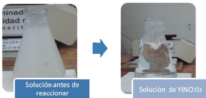
Figura (8). Solución de nitrato de itrio en el momento de la reacción.
