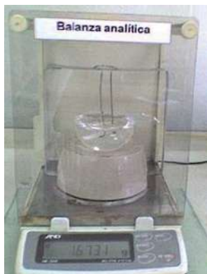
Figura (13). Determinación del peso sumergido de la muestra.
