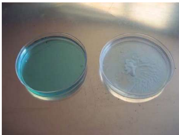
Figura (30). Celdas con solución de azul de metileno con catalizador y sin catalizador, irradiadas a 200 \times 100 \mu\text{J}/\text{cm}^2 por 5 minutos.
