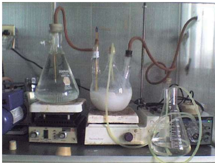
Figura (7). Equipo montado para producir pseudoboehmita.
