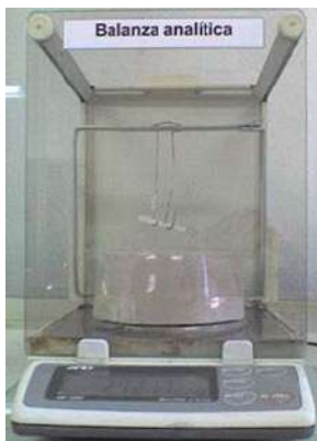
Figura (14). Determinación del peso saturado de la muestra.
