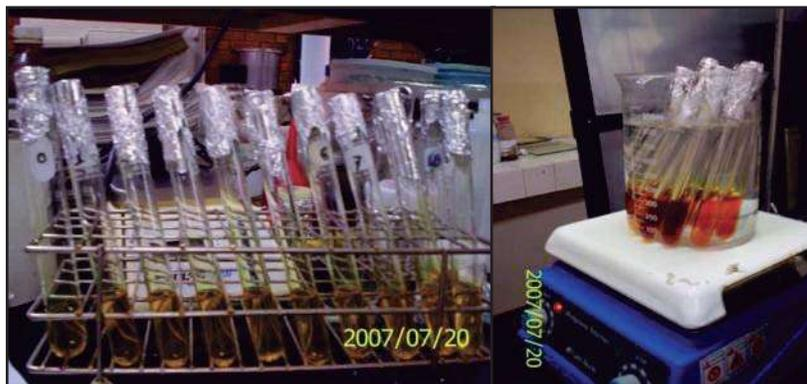
**Fig. 3.4.** Preparación de los tubos con DNS para la curva de curva de calibración y para las muestras
