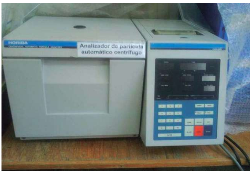
Figura 2.8. Analizador de partícula automático centrífugo HORIBA modelo CAPA 300, utilizado para la medición de aglomerados de \alpha -alúmina
