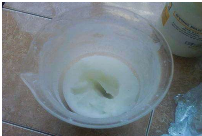
Figura 3.2. Formiato de aluminio filtrado y lavado, obtenido de una lámina de aluminio.
