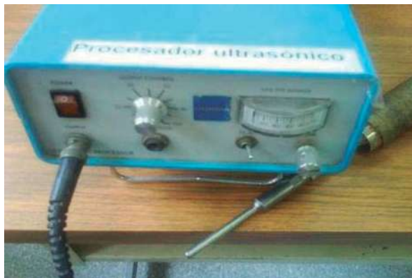
Figura 2.3 Procesador ultrasónico HORIBA, utilizado para disgregar las emulsiones.
