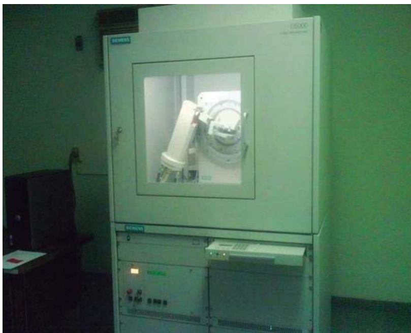
Fig. 2.7 Difractómetro de rayos X SIEMENS D5000, utilizado para el análisis DRX.
