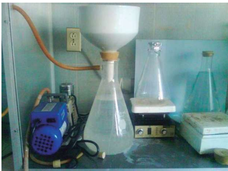
Figura 3.1. Proceso de filtración por medio de vacío del precipitado de formiato de aluminio formado.
