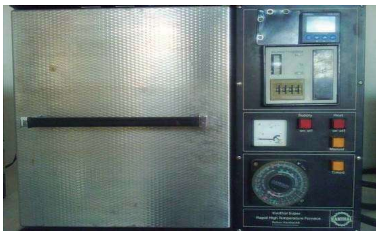
Figura 2.4 Imagen del horno Kanthal Super Rapid High Temperature Furnace utilizado por el proceso de calcinación.
