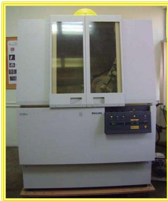
**Figura 38. Difractómetro de rayos X Philips X'PERT**
