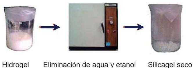
**Figura 17. Obtención del producto final silicagel**
