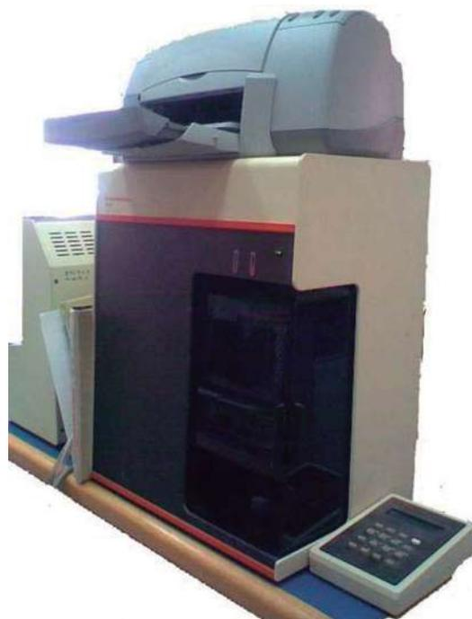
**Figura 42. Analizador de área superficial Gemini 2360 micrometric**
