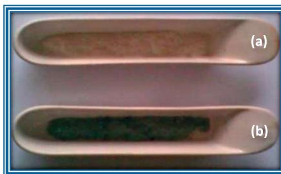
**Fig. 19 Muestras sometidas a tratamiento térmico a 350 °C en flujo de H<sub>2</sub>, SGCuM15%(a) y CuM15% (b).**
