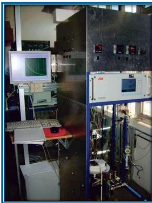
**Figura 48. Reactor para pruebas de actividad catalítica**
