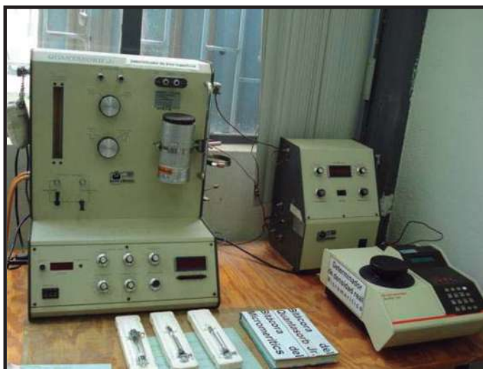
Figura 3.4. Equipo para determinación de área superficial QUANTASORB Jr. Instituto de Investigaciones Metalúrgicas, UMSNH.
