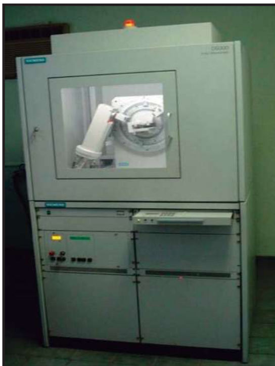
Figura 3.6. Equipo para difracción de rayos X SIEMENS D5000. Instituto de Investigaciones Metalúrgicas, UMSNH.
