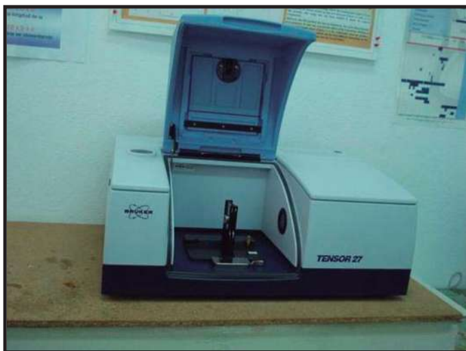
Figura 3.5. Equipo para espectrometría de infrarrojo BRUKER TENSOR 27. Instituto de Investigaciones Metalúrgicas, UMSNH.
