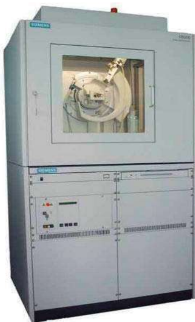
Figura 17. Equipo SIEMENS D5000
