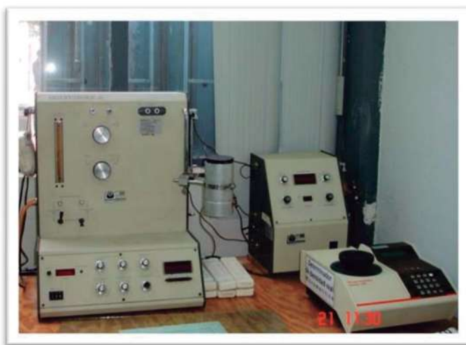
Figura no. 1.7.4.1. Fotografía del equipo que se utilizó para medir el área superficial del catalizador. El equipo es marca QUANTASORB y el modelo es QUANTASORB JR.
