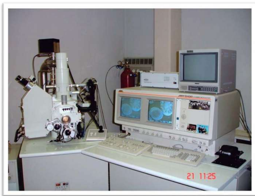
Figura no. 1.7.1.1. Fotografía del Microscopio Electrónico de Barrido que se utilizó en el proyecto para obtener imágenes del catalizador desde 2500 hasta 10000 aumentos. La marca de equipo es JEDL modelo JSM-6400 SCANNING MICROSCOPE.
