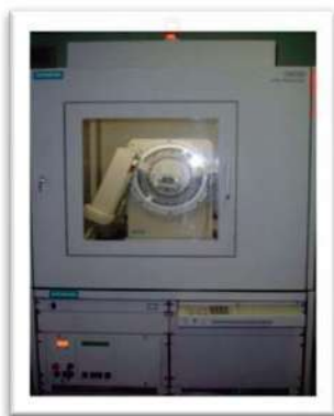
Figura no. 1.7.2.1. Fotografía del equipo que se utilizó para Difracción de Rayos X, el cual es marca SIEMENS modelo D5000 XRAY DIFFRACTOMETER.
