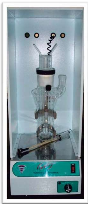
Figura no. 1.6.1. Fotografía del Reactor fotocatalítico utilizado en el proyecto para la parte de degradación del colorante azul ácido 9, el cual es marca ESEVE y modelo FOTO Q 200 REACTOR DE FOTOQUÍMICA.
