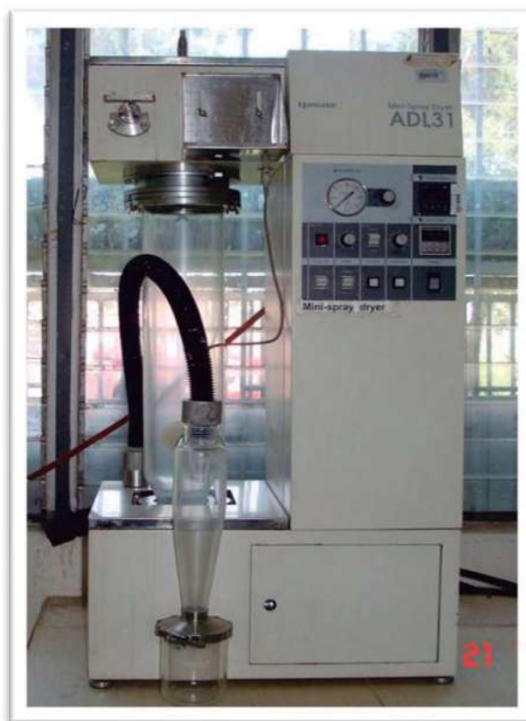
Figura no. 1.5.2. Fotografía del pulverizador o spray dryer que se utilizó para secar las muestras. El equipo es marca YAMATO y modelo ADL31 MINISPRAY DRYER.
