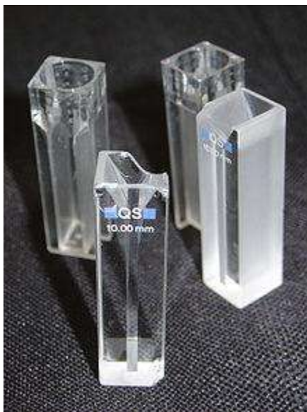
Figura 6. Celdas de espectrofotometría de cuarzo y de plástico.
