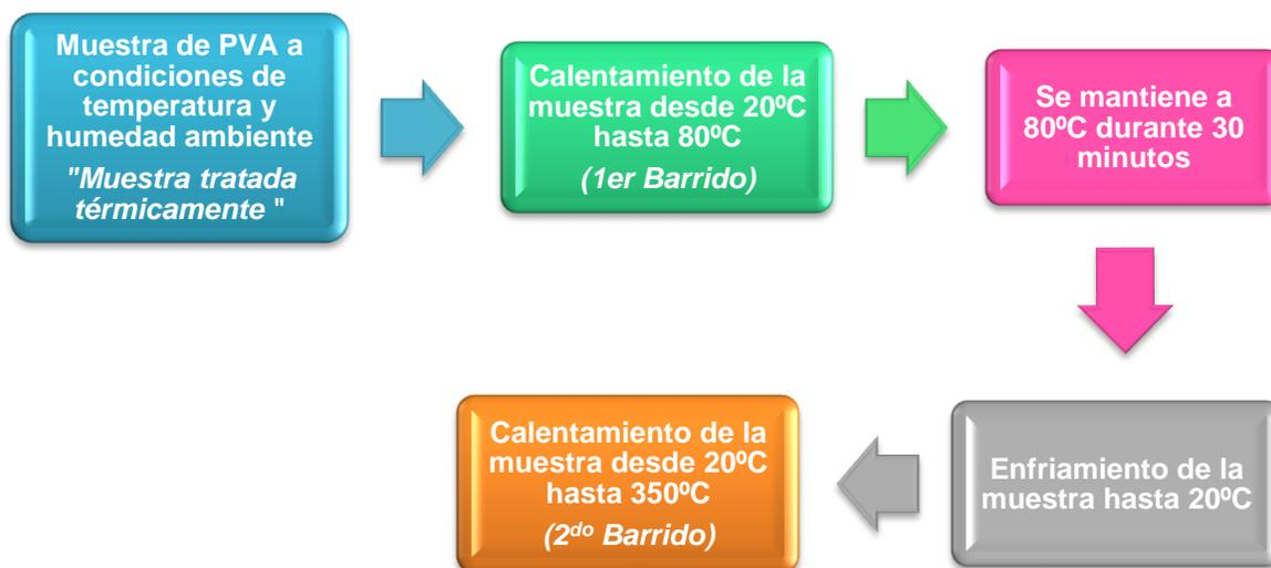
**Figura 43.** Tratamiento térmico de calentamiento-enfriamiento-calentamiento (H-C-H) para 80°C
