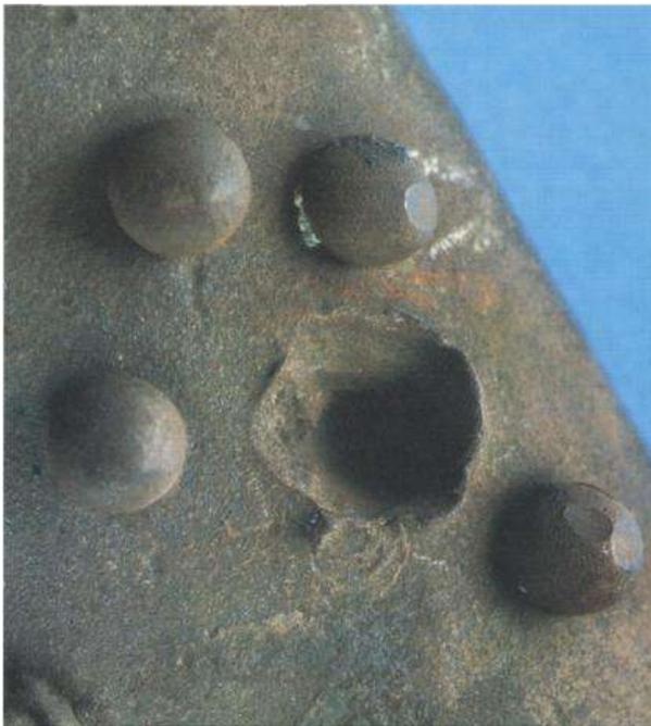
**Tubo con Daño Mecánico provocado por Sopladores Fig 7b**
