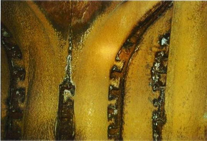
**Corrosión Interna Por Oxígeno Disuelto**
