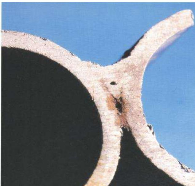
Aquí se muestra la Falla de la Soldadura en la Membrana Tubo-Tubo.
