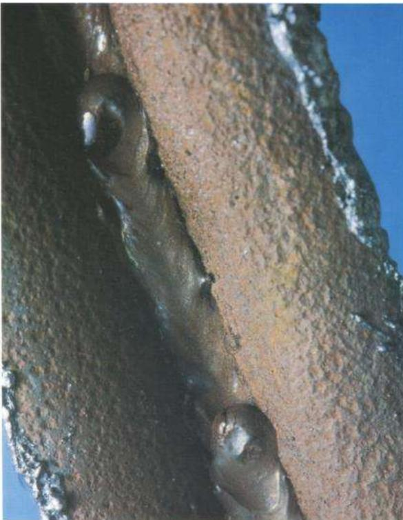
Se muestra nuevamente Falta de Control de Calidad en la aplicación de la soldadura y Falta de Inspección.
