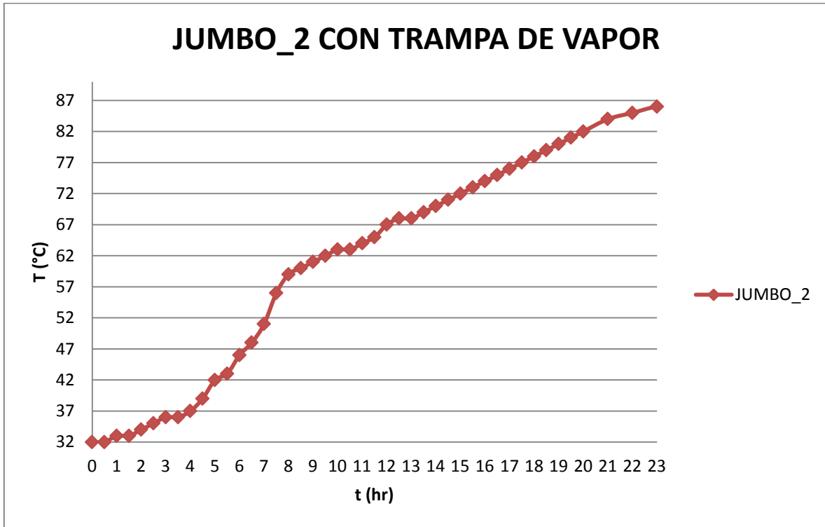
Figura 4.2.2: Segundo jumbo calentado utilizando trampa de vapor.
