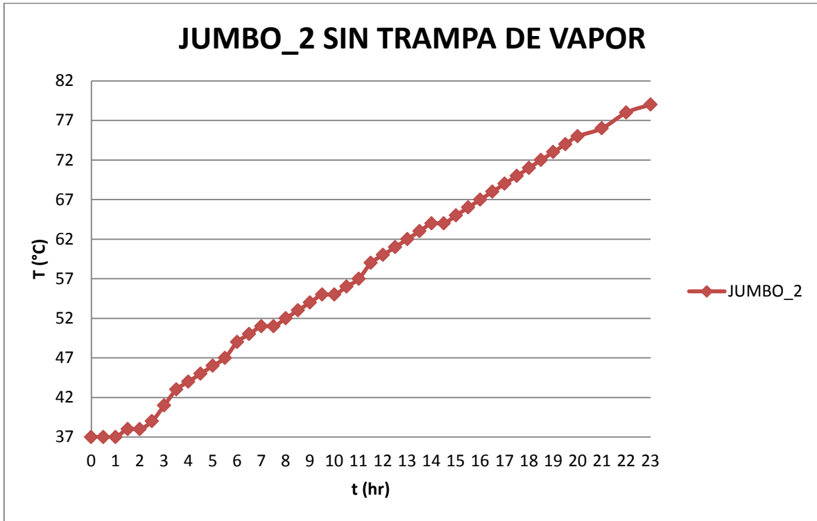
Figura 4.1.2: Segundo jumbo calentado sin utilizar trampa de vapor.
