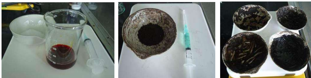
Figura 12.- Impregnación del TMA y Nitrato de níquel, en los soportes HMS/Al-HMS
