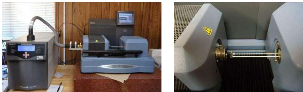
Figura 29.- Equipo para TGA-TPO, TA Instruments SDT Q 600
