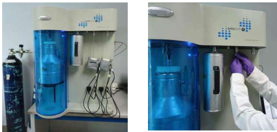
Figura 14.- Equipo Autosorb IQ 2 , Quadrachrome Instruments. Donde se realizó el análisis de Área superficial específica y tamaño de poro
