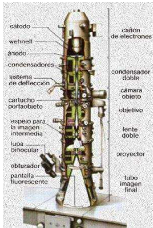
Figura 27.- Esquema general de un microscopio electrónico
