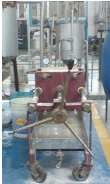
**Figura 6-1.** Filtro tipo prensa de marcos y placas utilizado en el proyecto.
