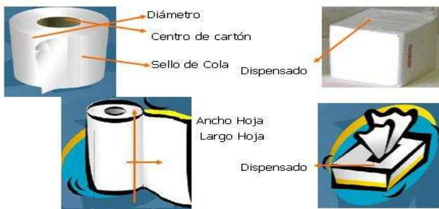
DIAGRAMA DE PARTES DE UN ROLLO.
