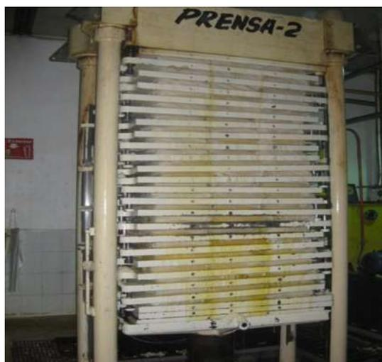
Figura 11. Prensa de extracción de aceite
