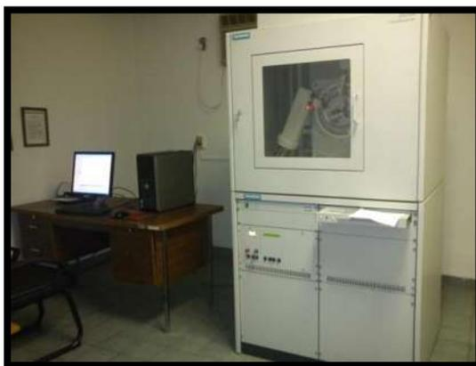
Figura 13. Equipo X SIEMENS D5000
