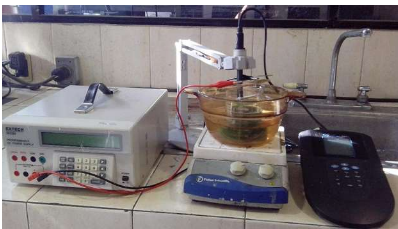
Figura 3. 4. Celda electrolítica donde se llevó a cabo la electrodeposición.
