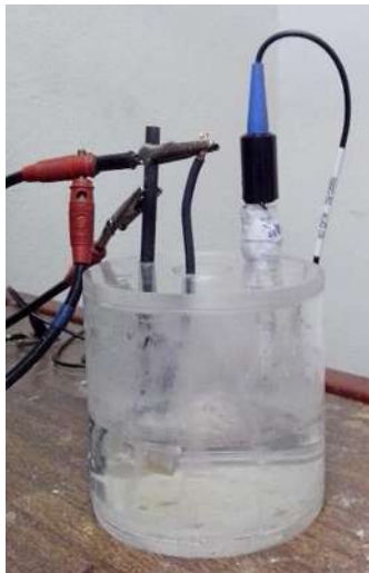
Figura 3. 8. Celda electrolítica para los ensayos de corrosión.
