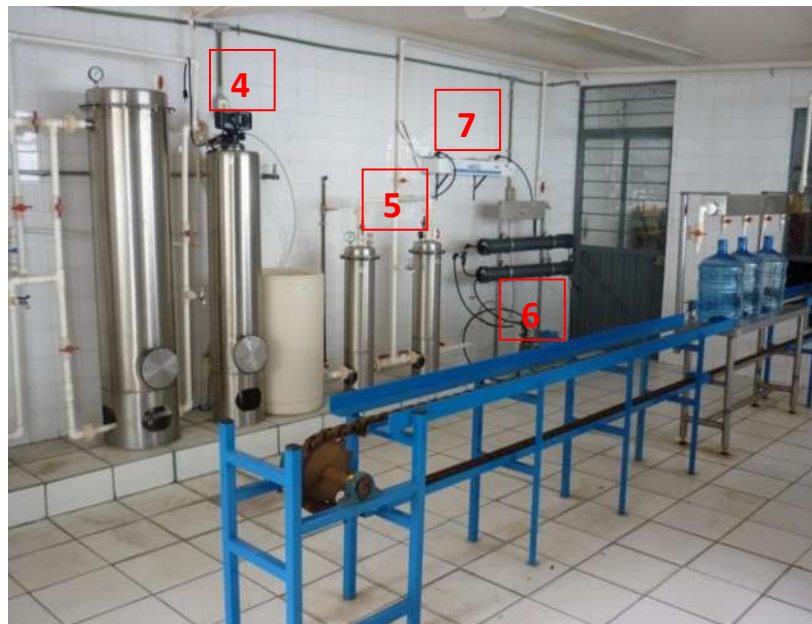
Figura 3. (4) Suavizador, (5) Microfiltros, (6) Ósmosis Inversa y (7) Lámpara UV.
