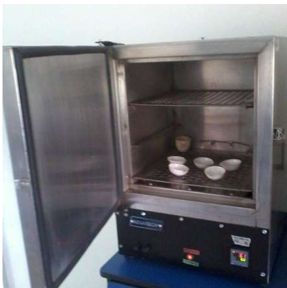
Figura 22: Cápsulas de porcelana en la estufa
