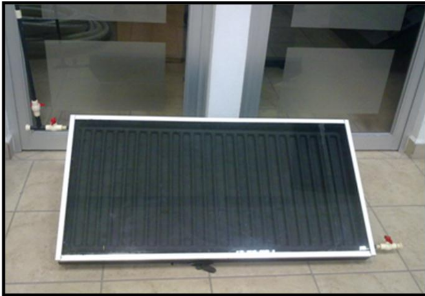
Figura 3.1.6.- Colector Solar terminado
