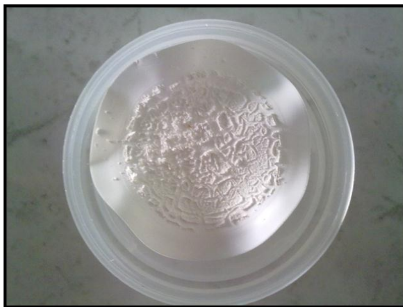
Figura 3.3.3.- Membrana con la sal extraída de la solución a una concentración de 75% acetona
