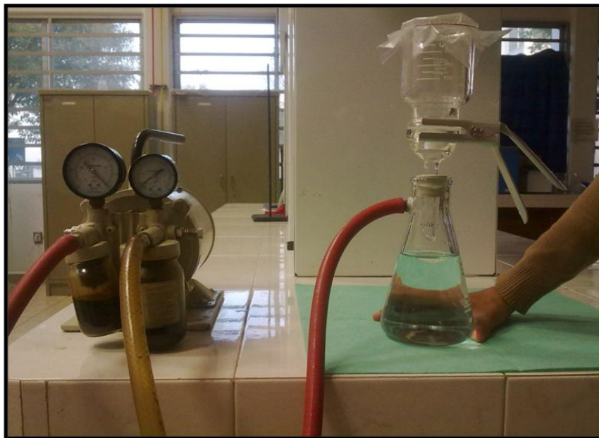
Figura 3.3.1.- Equipo de ultrafiltración y bomba de vacío.
