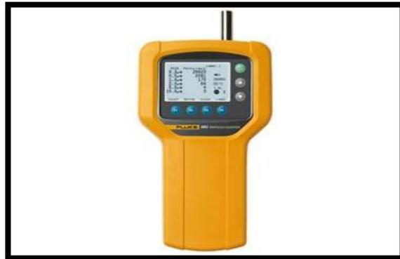
Figura 12. Contador de partículas Fluke 983.
